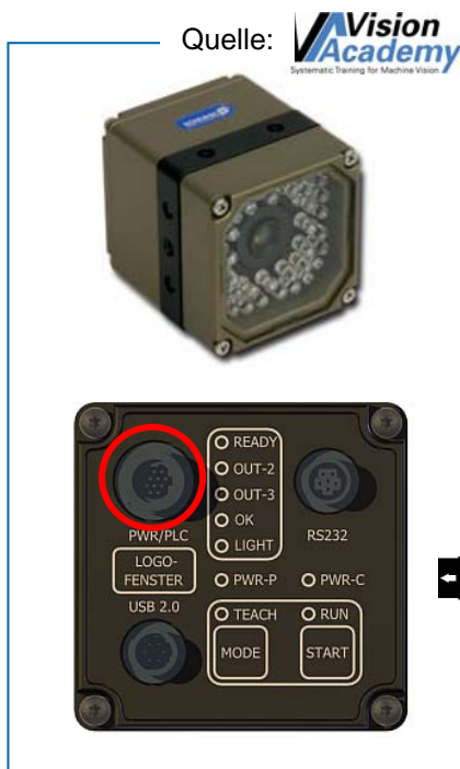
Bild 10: Schnittstellen des Beispielsensors SRV-300
