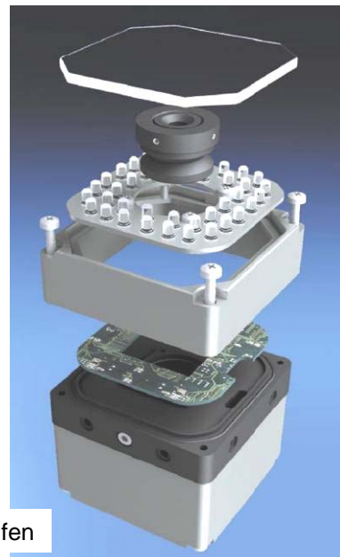
Bild 3: Die aktuelle Entwicklung von Vision Sensorik hin zu Kompaktgeräten
